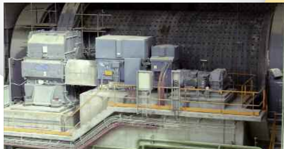
Entraînement de broyeur avec système double pignons alignants
