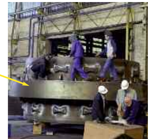
Bandage monté sur section de virole
